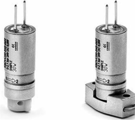
A eletroválvula K8DV foi desenhada para satisfazer todas as necessidades de intercetção de Fluidos agressivos ou sensíveis ao calor. Graças à membrana de separação, o Fluido está isolado das partes metálicas internas da eletroválvula, e evita o calor gerado pelo solenoide.
